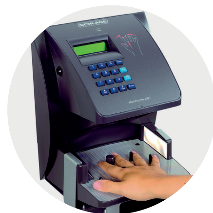
DISPOSITION DE LA MAIN LORS DE L'ENREGISTREMENT Avancer la main jusqu'à la butée, puis serrer les doigts.
