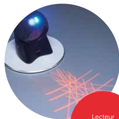
Lecteur laser intégré dans le tourniquet.
